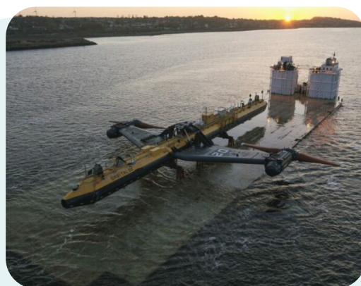
Figure 2 : Hydrolienne Orbital Marine Power à flux axial flottant
