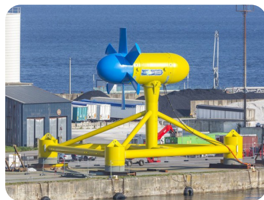
Figure 1 : Hydrolienne Sabella à flux axial à embase gravitaire
