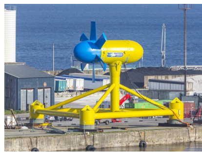
Hydrolienne Sabella à flux axial à embase gravitaire avant remise à l'eau
